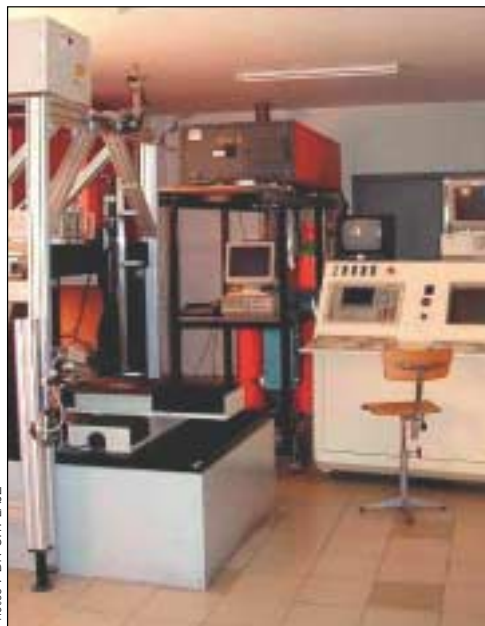
Lasers à excimères et table XYZ pilotée par commande numérique.
