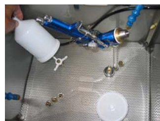
Figure 32 : Nettoyeur de pistolets avec un éco-nettoyant
